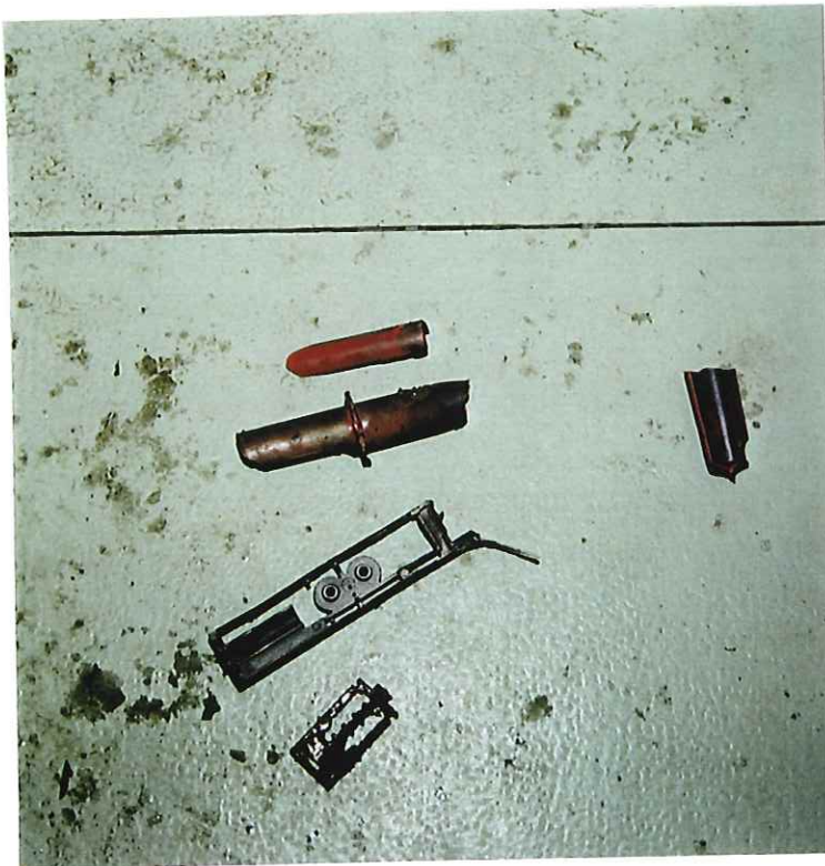
Fotot visar hopplockade delar från spänningsprovaren.
